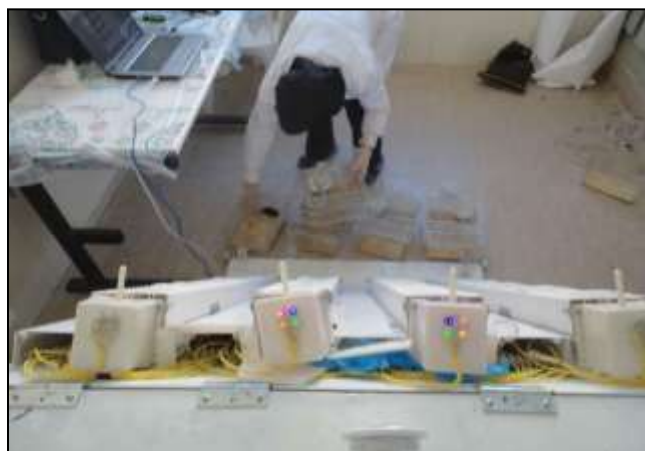
شکل ۵- نصب محرک نوری در طرفین کانال هر نردبان
