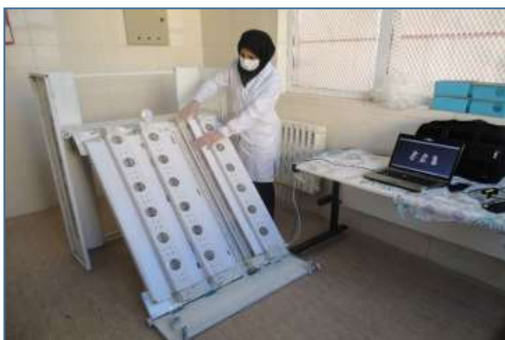
شکل ۷- نردبان زاویه متغیر با زاویه ۶۰ درجه
