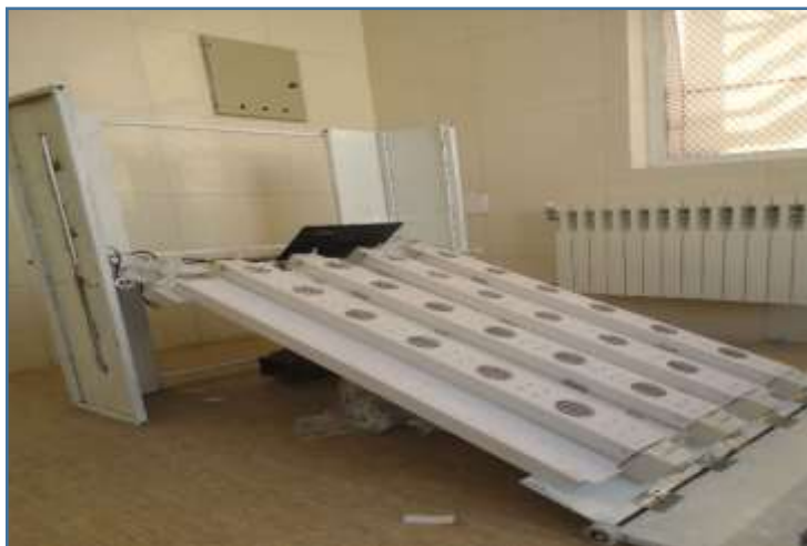
شکل ۶- نردبان زاویه متغیر با زاویه ۳۰ درجه
